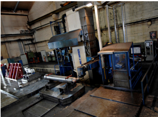
CNC Bohr- Fräsbearbeitungszentrum
